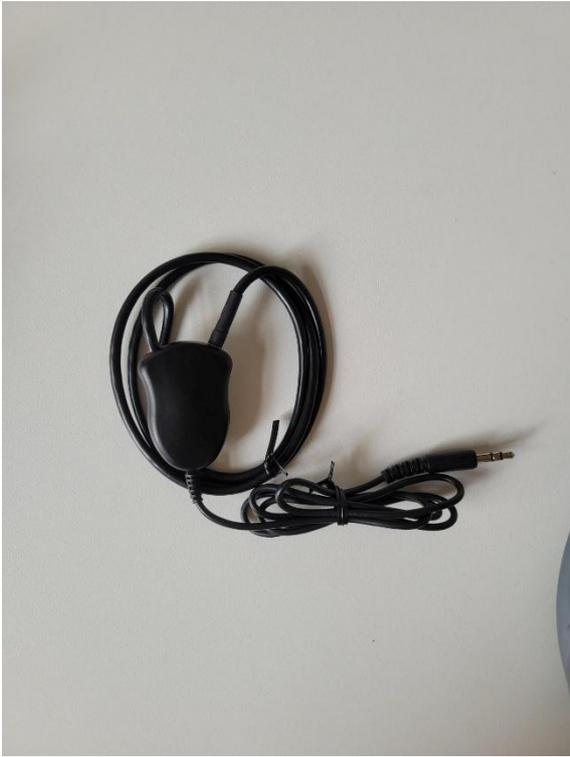
Bild 13: Haldringschleife für induktives Hören
